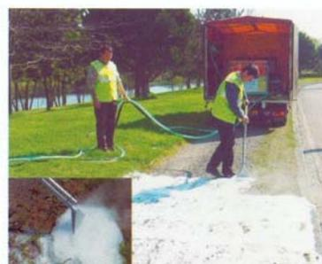
Modèle expérimenté : système Waipuna. Ce matériel peut être utilisé sous réserve que le produit (mélange de noix de coco et amidon de maïs) soit homologué en France.
