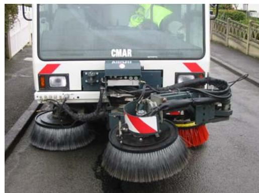
Photo n°5 et 6 : Balayeuse automotrice de la Ville de Tréguier montée de deux balais métalliques et d'un balai souple.
