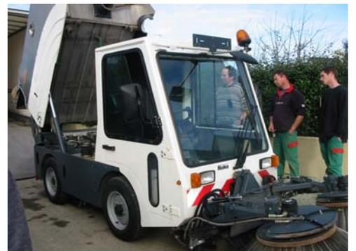
turbine ramasse les débris, déchets et poussières et les envoie dans la grande benne à déchets en inox d'un volume de 1,7 m<sup>3</sup>. Cette machine dispose en option d'un tuyau d'aspiration à main, permettant le nettoyage aisé des regards d'eaux pluviales.
