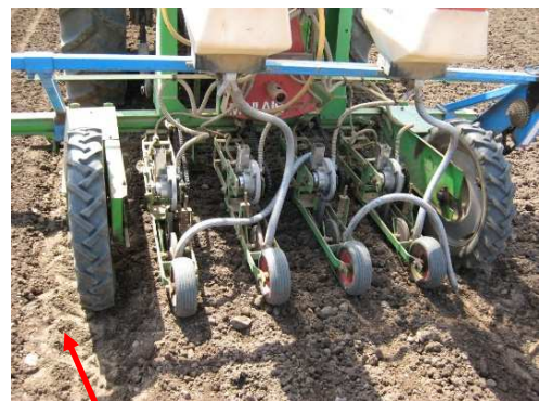
Zone de tassement marquée au niveau du passage de roues d'un semoir
